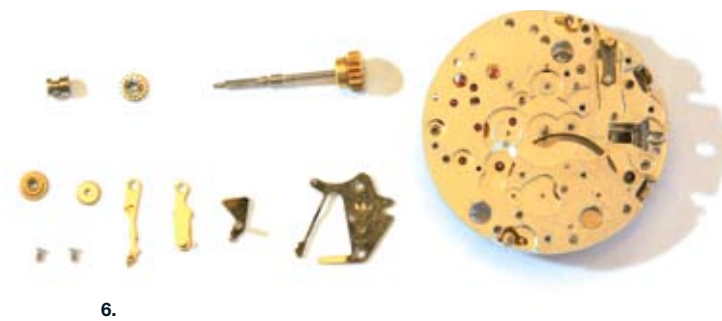
5. Minutería. 6. Tija. 7. Rotor.
