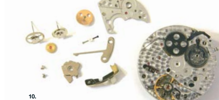
8. Puente del sistema automático. 9. y 10. Cronógrafo. 11. Tren de rodaje.
